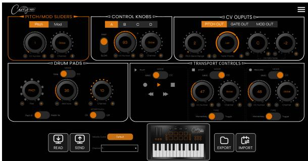
L'applicazione Carry-on Control offre una configurazione completa di tutti i controlli disponibili sul controller richiudibile MIDI Carry-on FC25. Una volta configurato lo schema di controllo perfetto per le vostre esigenze, l'applicazione Carry-on Control consente di salvare e richiamare facilmente l'intera configurazione.
