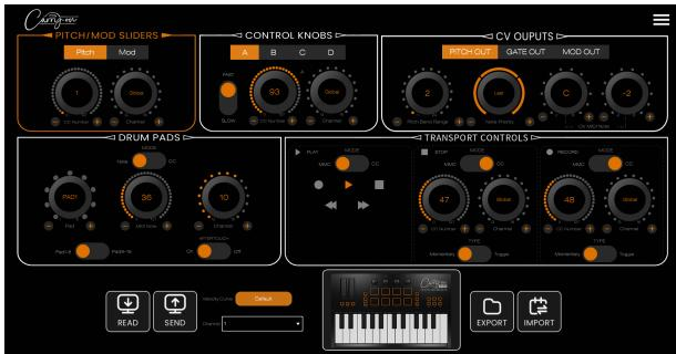
La app Carry-on Control ofrece una configuración completa de todos los controles disponibles en tu Controlador MIDI Plegable Portátil FC25. Una vez que hayas configurado el esquema de control perfecto para tus necesidades, la app Carry-on Control permite guardar y recuperar fácilmente la configuración completa.
